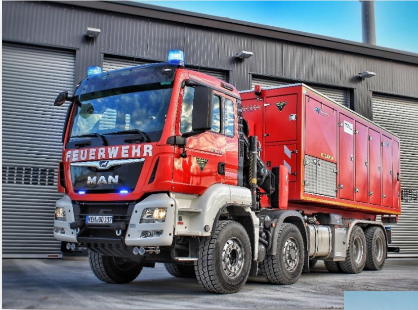
1 WLF mit Kran in Neustadt Aufbau: ATS/ HIAB, Fahrgestell: MAN TGS 35.420 8x6H
