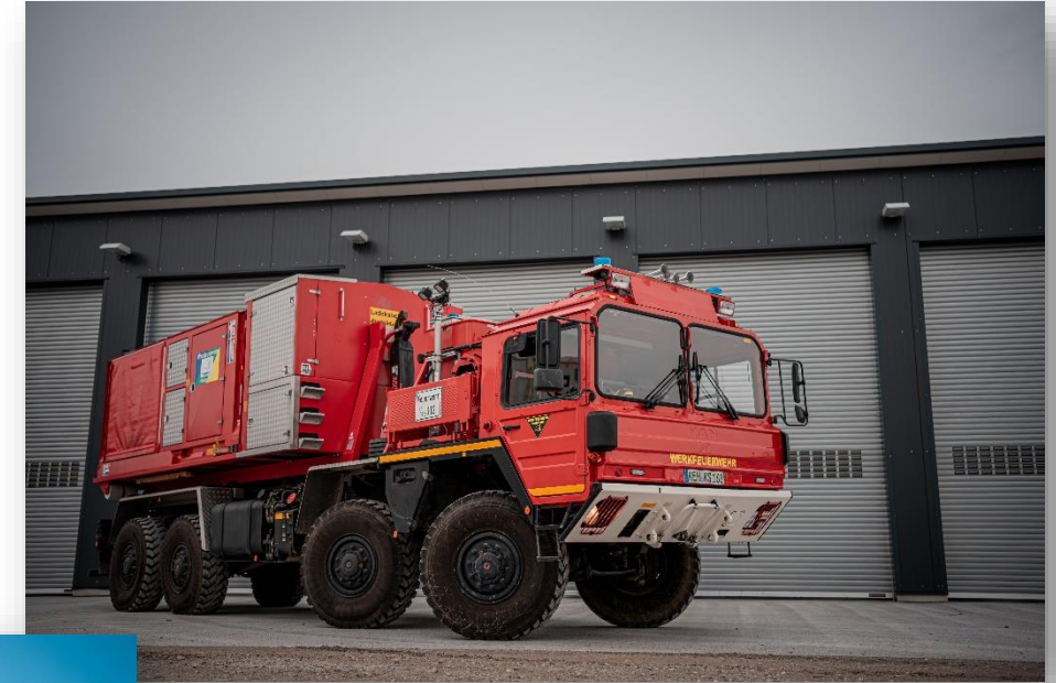
1 WLF in Neustadt Aufbau: HIAB, Fahrgestell: MAN 15t MIL GL W A 1 8x8
