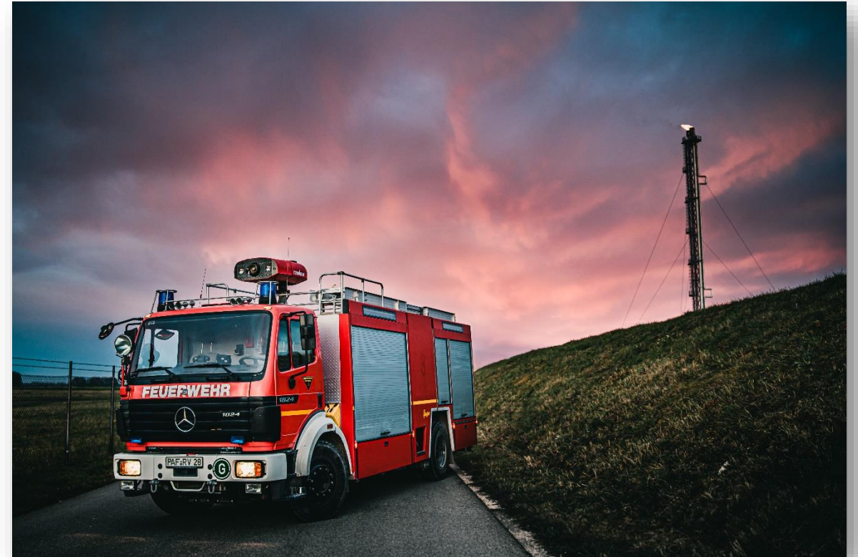
1 Fahrzeug des Typ ULF 28 / 10 - 10 – 20 – 1,2 Aufbau: Ziegler– Fahrgestell: Mercedes SK 1824
