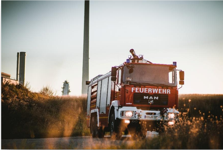
1 Fahrzeug des Typ ULF 40 / 40 – 10 – 20 – 1,2 Aufbau: Rosenbauer, Fahrgestell : MAN FE 410 A
