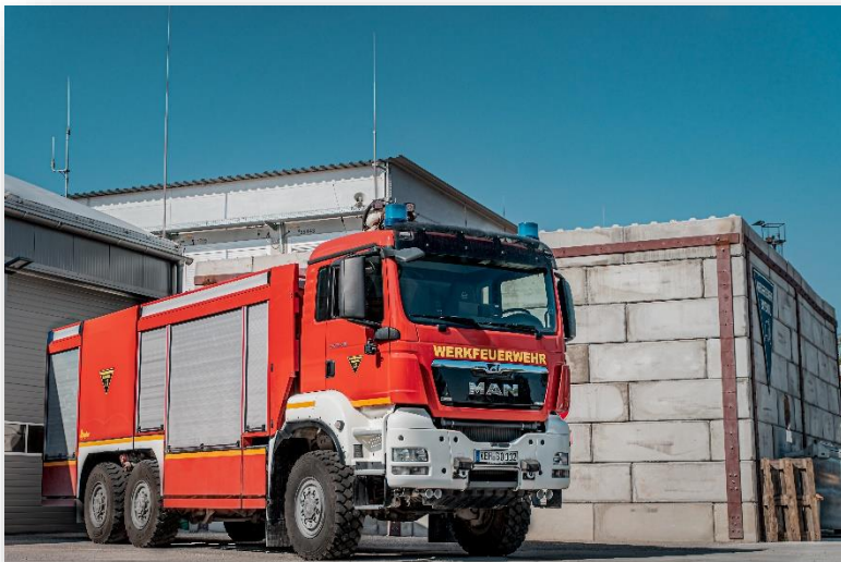
1 Fahrzeug des Typ ULF 30 / 45 – 10 – 20 – 1,2 Aufbau: Ziegler, Fahrgestell: MAN TGS 33.400 6x6
