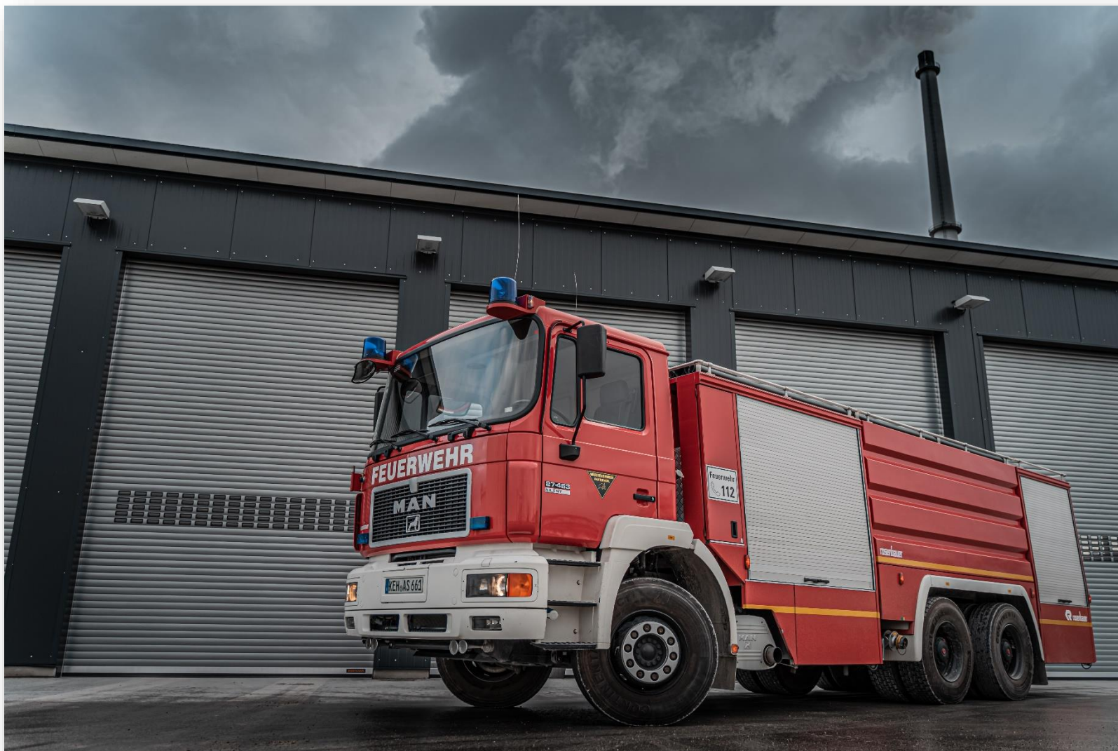
1 Fahrzeug des Typ SLF 10.000 Aufbau: Rosenbauer, Fahrgestell: MAN 27.463 Silent
